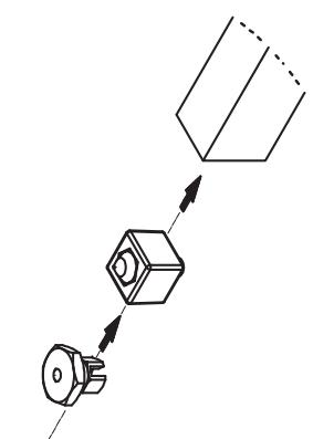
Inserire nel binario lungo battuta (Art.0200/59) e il perno regolazione anta avvitato nel dado esagonale speciale di Sp.4mm e angolo especial de 4mm de espesor.
