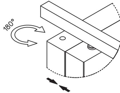
Una volta inserito correttamente il carrello nel binario lungo impacchettare le ante e ruotarle di 180°.
