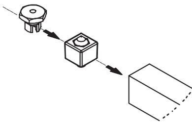
Inserire nel binario lungola battuta (art.0200/59) e il perno regolazione anta avvitato nel dado esagonale speciale di Sp.4mm
