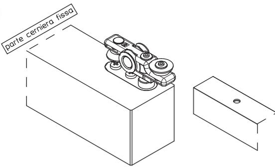
Inserire il carrello (art.0200/56) nel binario, con la ruota orizzontale montata verso l'alto rivolta dalla parte dove vi è montata la staffa d'aggancio laterale inferiore (Art.0290/51)
