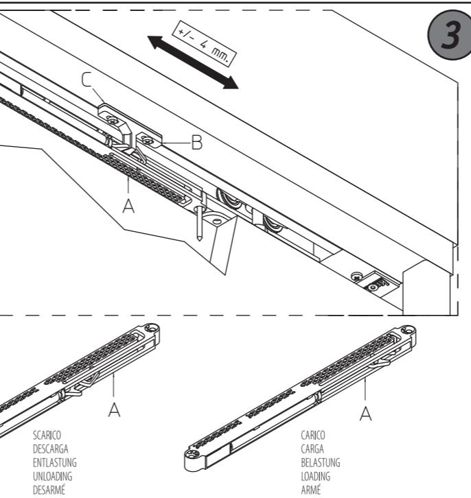
\*Installato il pannello, portarlo in battuta in chiusura e regolare, se necessario, la staffa "B" allentando le viti "B1". Verifica finale: aprire la porta e scaricare il sistema di chiusura "A". Chiudere la porta verificando il corretto accoppiamento tra "A" e "B".
