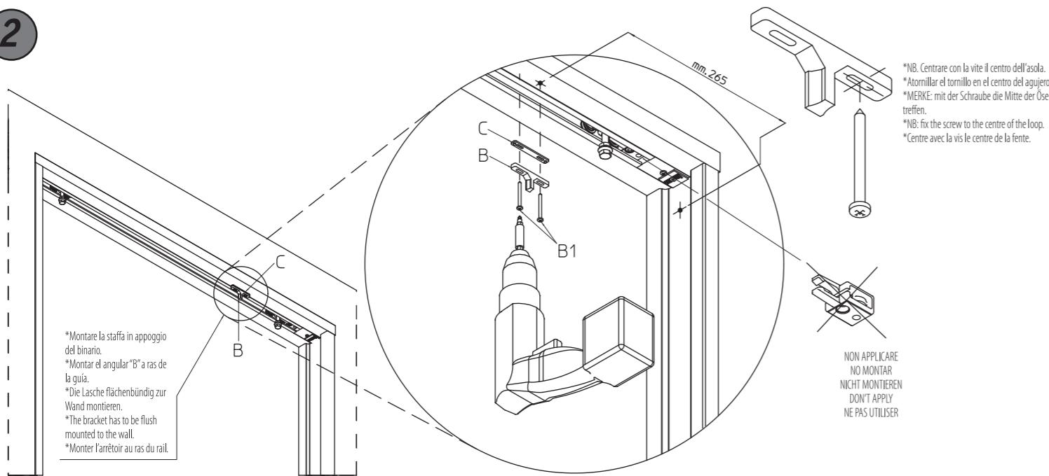
\*Fissare la staffa di chiusura "B" in accoppiamento con il distanziale "C" sul traverso. Utilizzare le viti in dotazione "B1" TC Ø3,5x40 DIN 7505-B. Per il suo posizionamento fare riferimento alle quote indicate. Aggiungere o togliere i distanziatori "C" in dotazione per ottenere il giusto accoppiamento verticale tra staffa "B" ed il sistema di chiusura "A".
