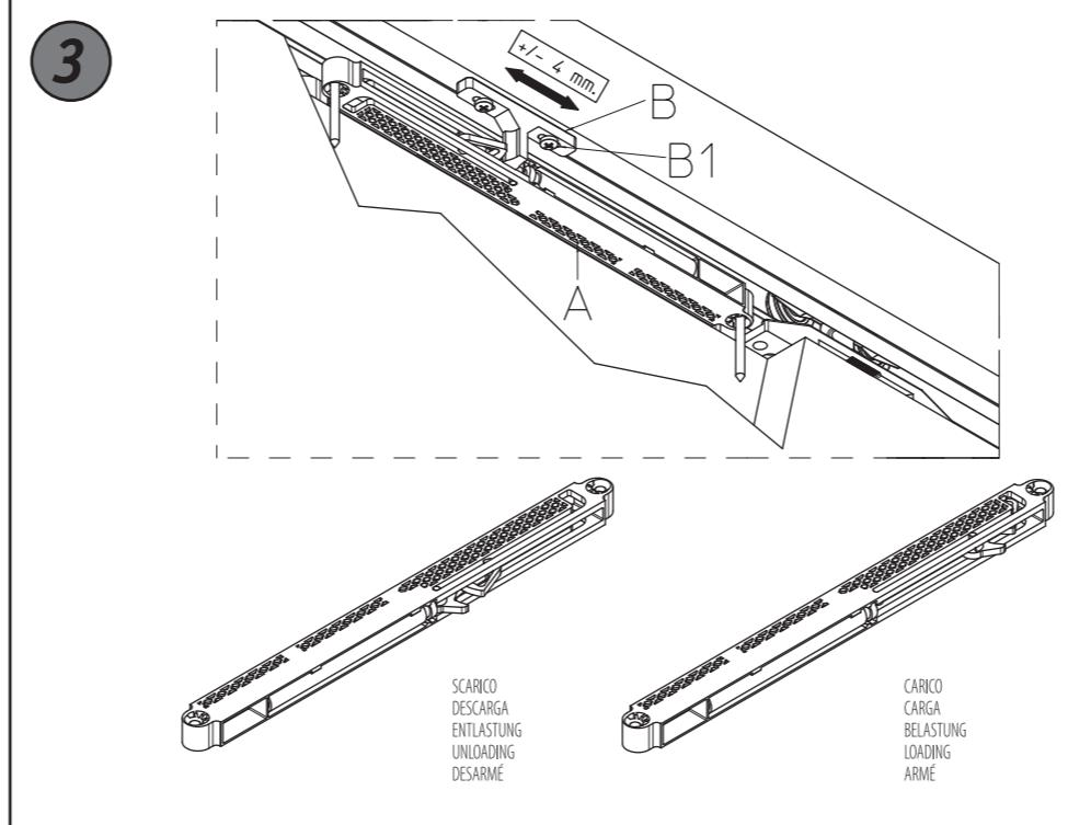
\*Installato il pannello, portarlo in chiusura ed apertura e regolare, se necessario, la staffa "B" allentando le viti "B1". Verifica finale: aprire/chiedere la porta e scaricare il sistema di chiusura e d'apertura "A". Aprire e chiudere la porta verificando il corretto aggancio tra "A" e "B".
