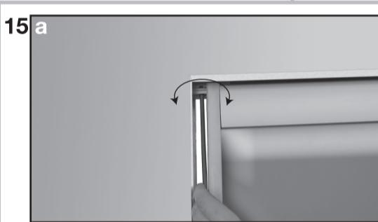
\*Regolare l'anta tramite le apposite viti di regolazione.
