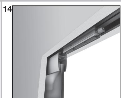
\*Inserire il secondo carrello nel binario ed infilare la staffa nella guida anta.
